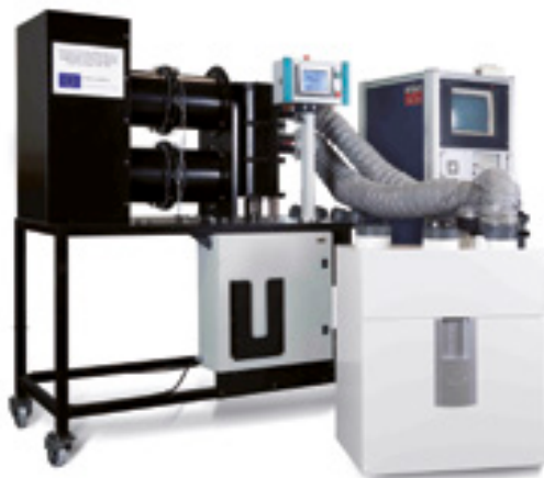
Testovací zařízení pro kontrolu parametrů malých rekuperačních jednotek, testuje se 100 % výrobků, včetně archivace dat
