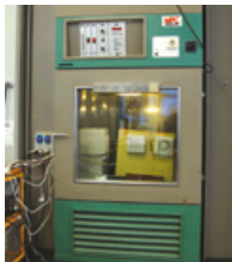
Klimatická komora pro testování ventilátorů při extrémních hodnotách teplot, vlhkosti, slanosti prostředí a UV záření
