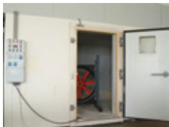
Klimatická komora pro testování ventilátorů při extrémních hodnotách teplot, vlhkosti, slanosti prostředí a UV záření
